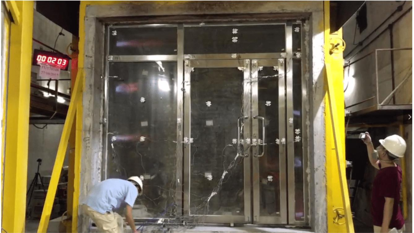
Prueba de puerta corredera de aluminio templado doble vidrio ignífugo de puerta corredera
