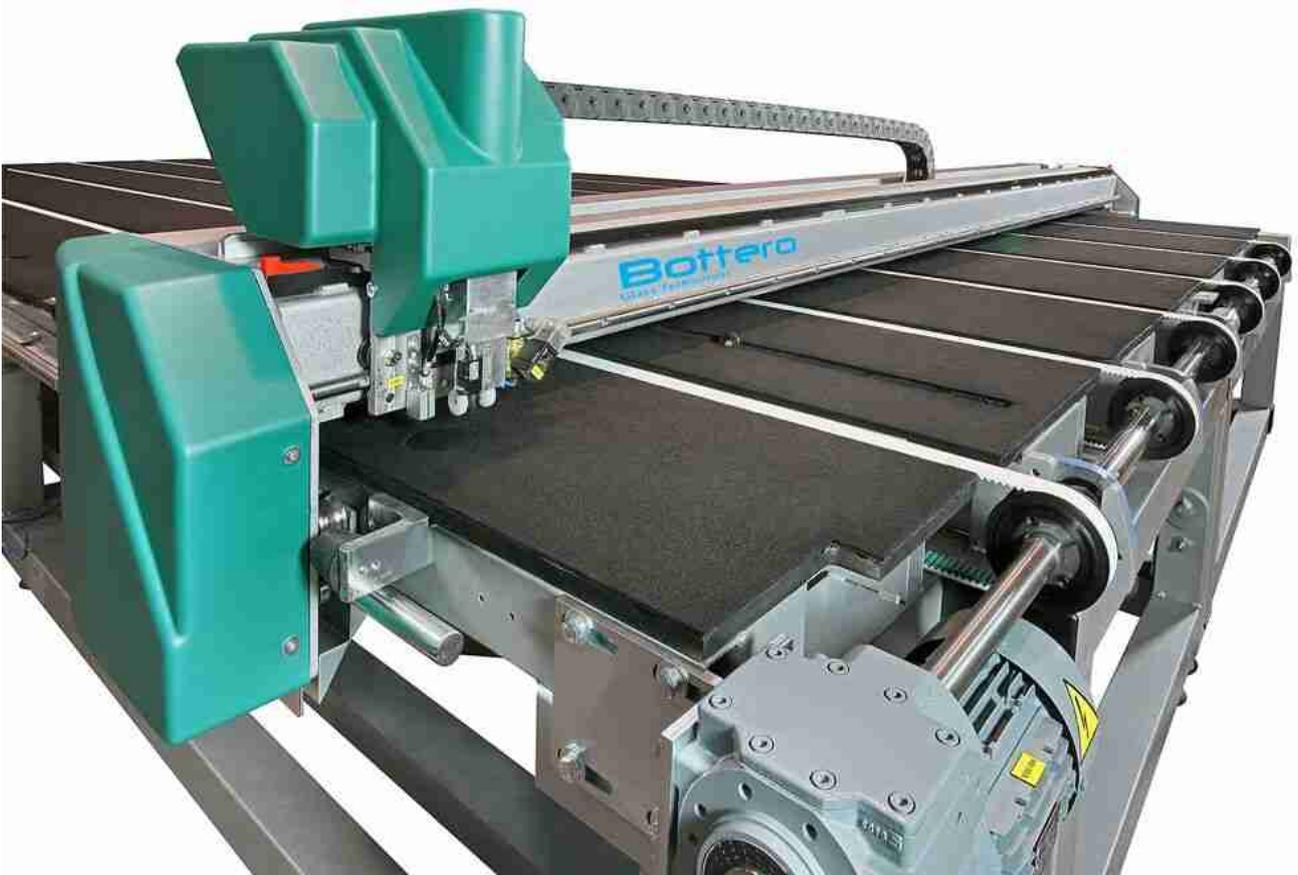
Corte preciso del tamaño del vidrio por máquinas avanzadas sin virutas sin arañazos
