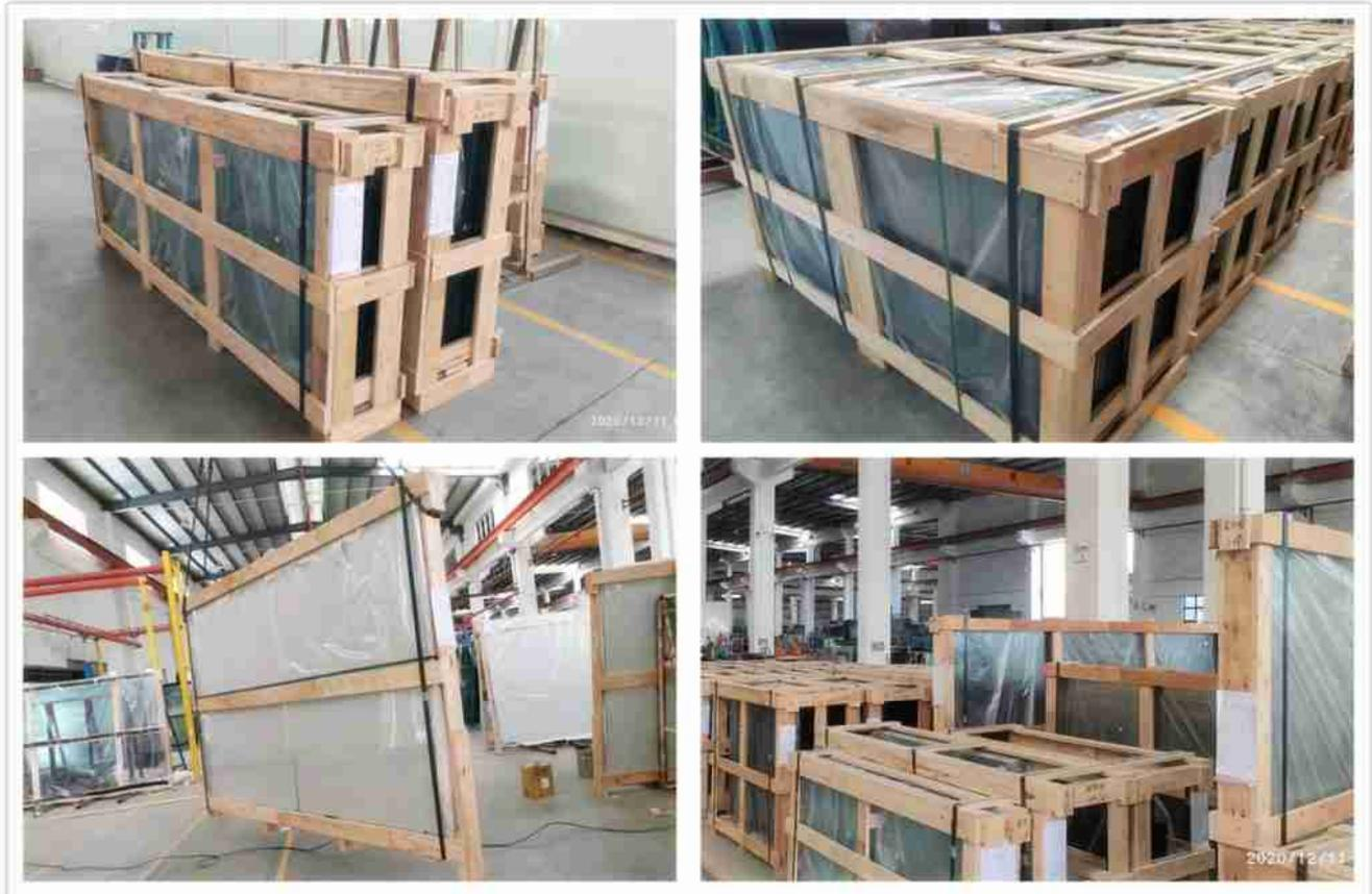
*Fuertes crats de madera contrachapada empacando para garantizar la seguridad del vidrio de la puerta de la pantalla del metro.*
