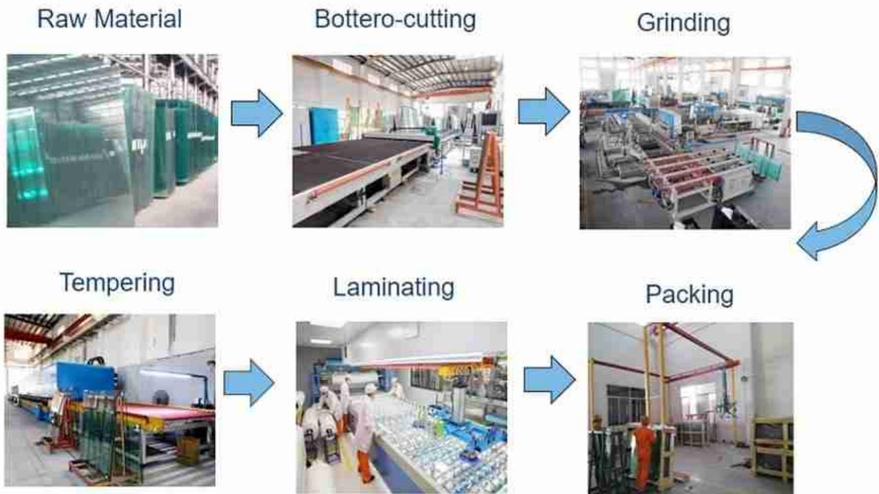
*Detalles de producción de balaustrada de vidrio laminado templado claro de 10+1.52pvb+10mm para cubierta*
