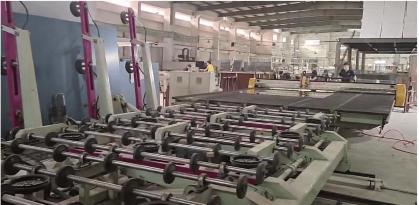
La línea de corte automático como se muestra incluye el sistema de marcha de mainframe/equipo del equipo del equipo/sistema de transmisión del equipo/sistema de aspiración de vacío / vuelco mecánico del sistema.
