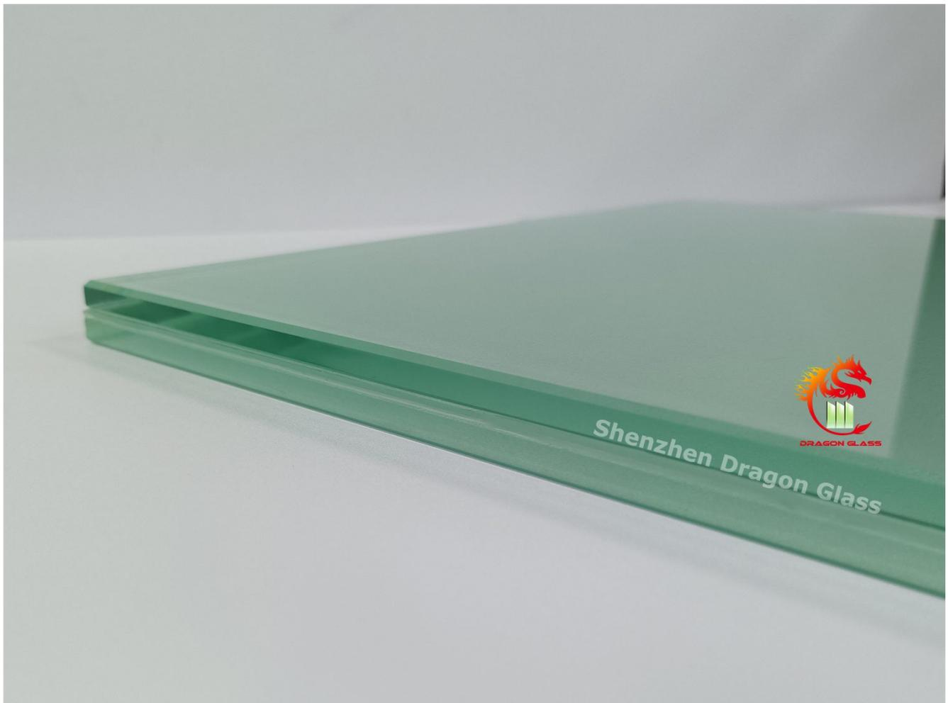
Se combina con una pieza de vidrio arenado de 8 mm y una pieza de vidrio transparente de 8 mm deshuesado con interlámina SGP de 1,52 mm.
