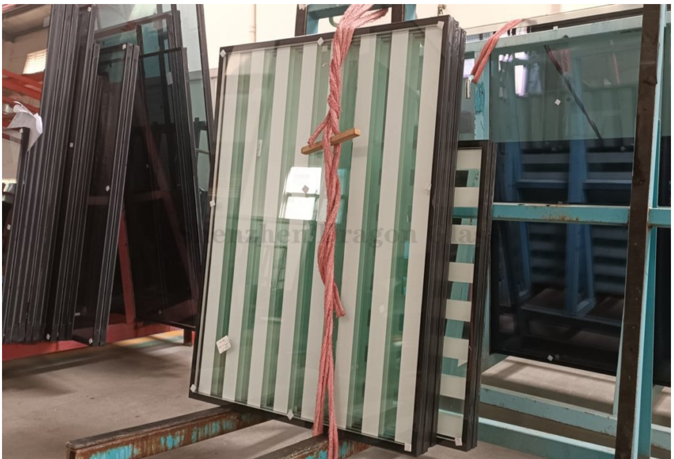
Paneles de vidrio aislado de 8 mm + 12A + 8 mm para ventanas
