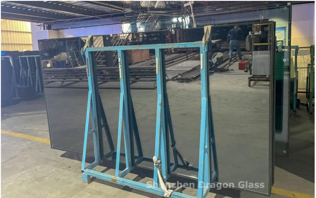
El doble acristalamiento Low e es el más utilizado para el muro cortina de vidrio. Alrededor del 70% de la pérdida de energía ocurre en ventanas de vidrio. El vidrio aislado low e está diseñado para minimizar la cantidad de infrarrojos y ultravioletas que entran por sus ventanas y permitir el paso de la luz natural.
