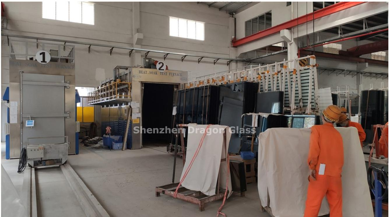
*horno de prueba de remojo de calor*
