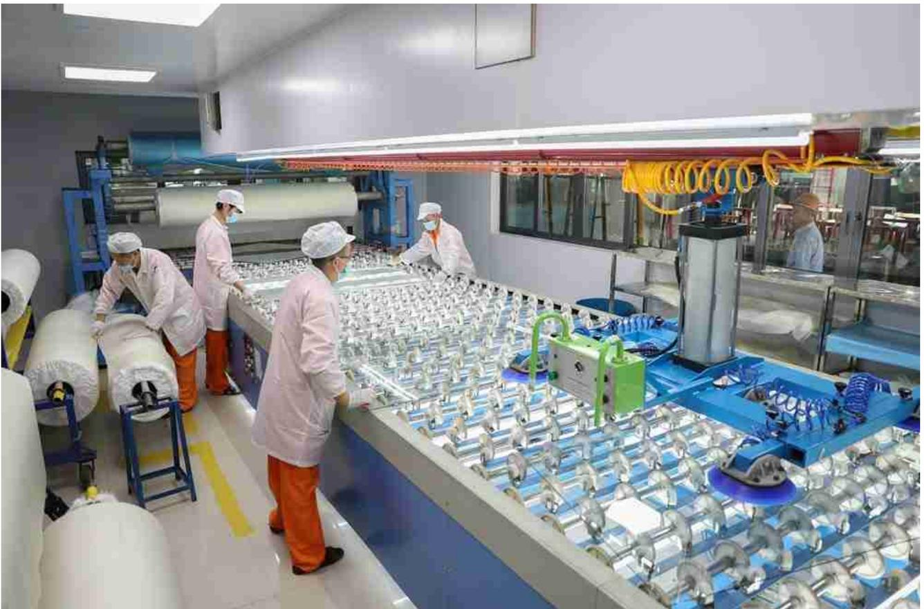
La producción de vidrio laminado húmedo y vidrio laminado eva debe ser rejuntó/combinado en un ambiente limpio para evitar la contaminación del pegamento/película EVA durante el proceso
