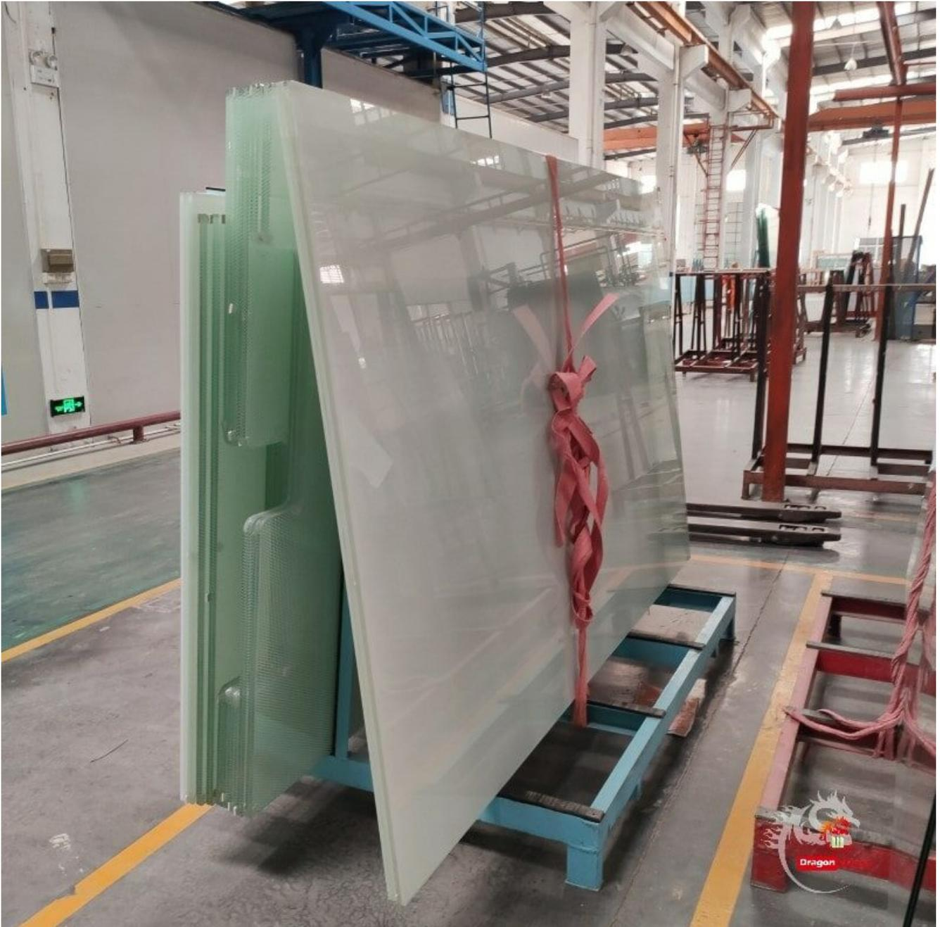
Wärmeverstärktes Glas gewinnt als innovatives Material für den Einsatz in der Bauindustrie zunehmend an Bedeutung. Der Prozess der Wärmeverfestigung ist eine spezielle Version der gebräuchlicheren Vorspanntechnik und kann Glas mit überlegener Festigkeit und einer höheren Bruchfestigkeit als normales
