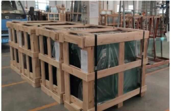
Starke Sperrholzkistenverpackung, um die Sicherheit der Verbundglasprodukte während des Ferntransports zu gewährleisten.
