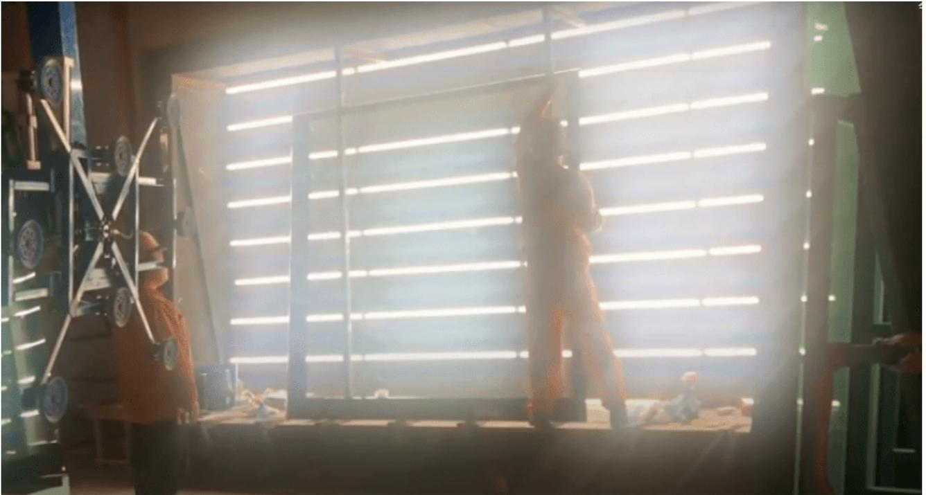
Shenzhen Dragon Glass Glas Aussehen Qualitätskontrolle, einschließlich Dimension, Aussehen, Bogen und Kett. Durch Lightbox, überprüfen Sie durch prospektive Beobachtung, und visuelle Überprüfung, und Stahl Lineal.
