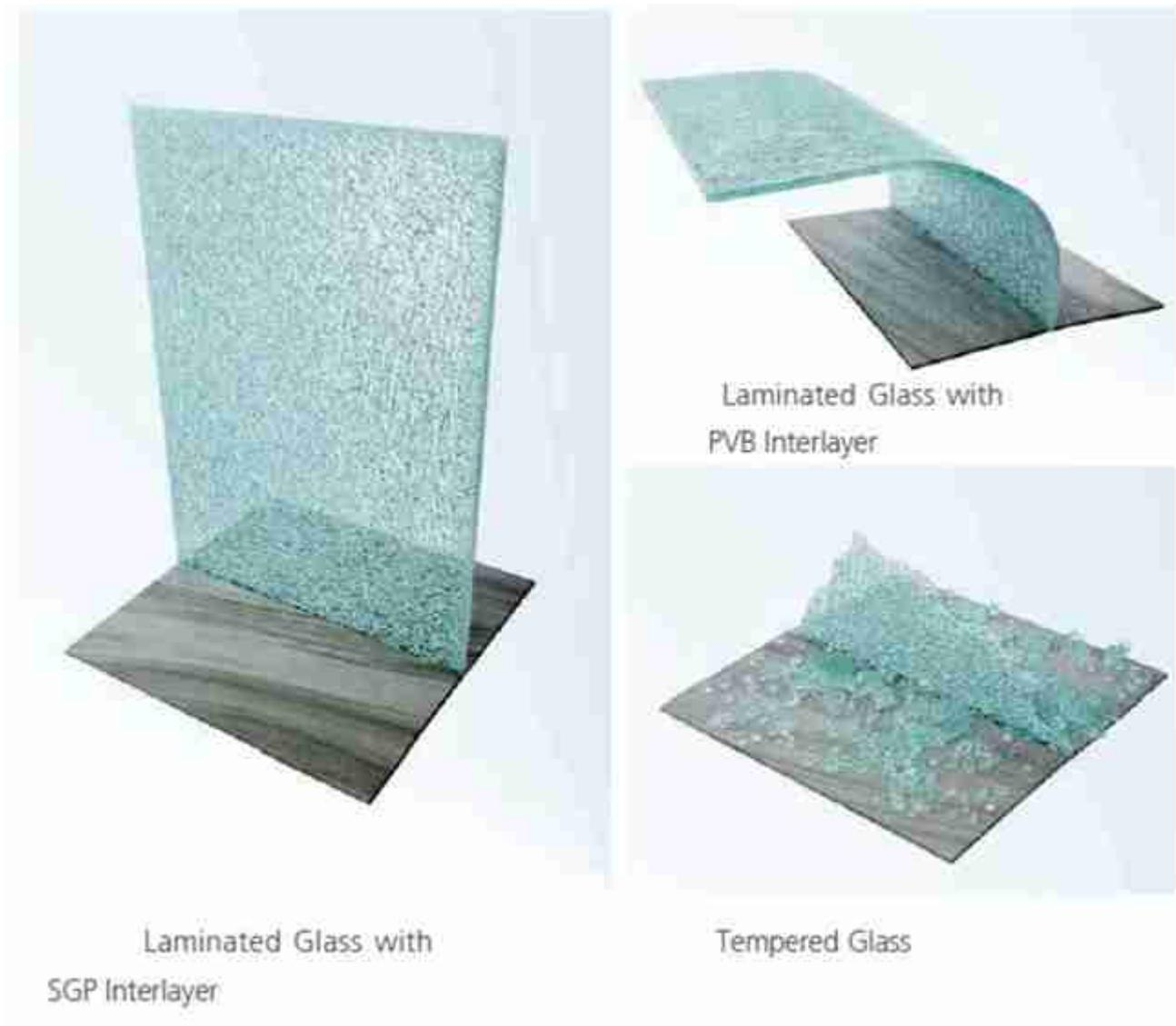
Sie fragen sich vielleicht, was ist der Unterschied zwischen [PVB Verbundglas VS SGP Verbundglas](#)? Nun, für den Prozess gibt es keinen großen Unterschied. Aber für das Zwischenschichtmaterial wird SGP Verbundglas 5 mal höher als PVB-Verbundglas und bis zu 100-mal steifer als normales PVB-Verbundglas sein.
