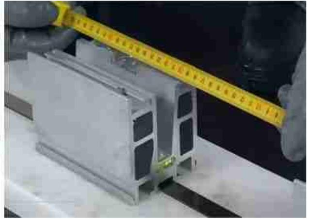
**3. Installieren Sie die u-förmige Nut und legen Sie in das spezielle Band:**
