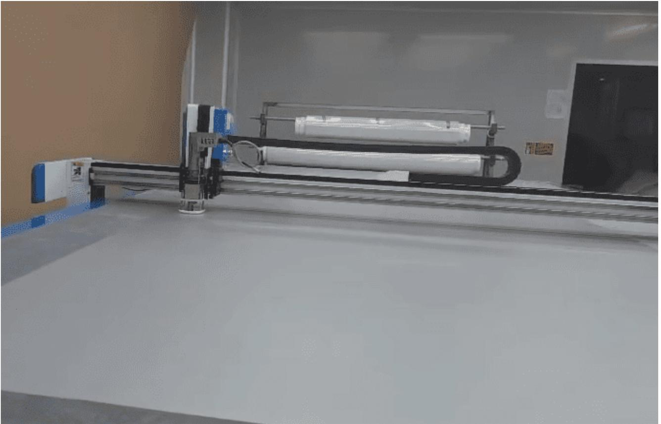
Die fortschrittlichste Schneidemaschine arbeitet daran, DIE PDLC-Folie in der tatsächlichen Größe zu schneiden. Polymer Dispersed Liquid Crystal (PDLC) Film sind eine Art von intelligenter Verglasung oder Folie, die ihre Transparenz als Reaktion auf einen elektrischen Impuls ändern. PDLC-Bildschirme wurden sowohl im Innen- als auch im Außenbereich zur Datenschutzkontrolle (z.B. Konferenzräume, Intensivstationen, Bad-/Duschentüren, Einbauräume) oder als temporäre Projektionsfläche eingesetzt.
