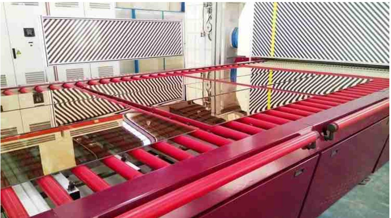
*Offline Low-E Glastemperiermaschine*
