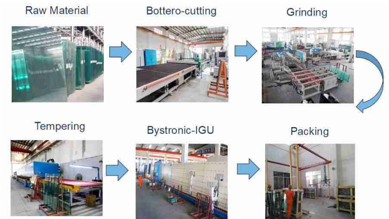
Der Produktionsprozess für Fenster Doppelglas.
