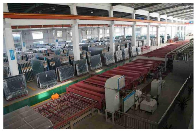
Großflächige Vakuum low e Glas magnetische Sputterlinie Die doppelt verglaste Produktion wird von unserer weltweit fortschrittlichen Bystronic Isolierlinie durchlaufen, die 100% Argongas-Injektionreinheit und Dichtungsqualität garantieren kann.
