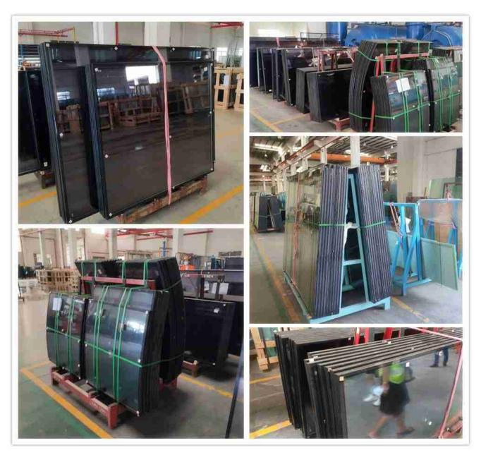
Argon Gas gefüllt Doppelverglasung Glas, gekrümmte Form und flache Form.
