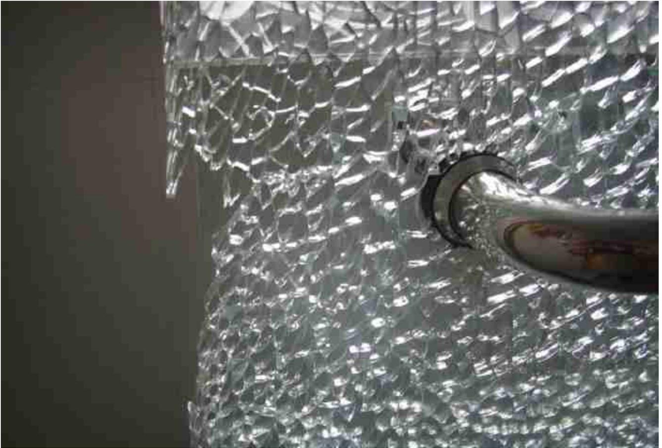
*Gehärteter Glasbruch mit explosionsgeschützter Folie*
