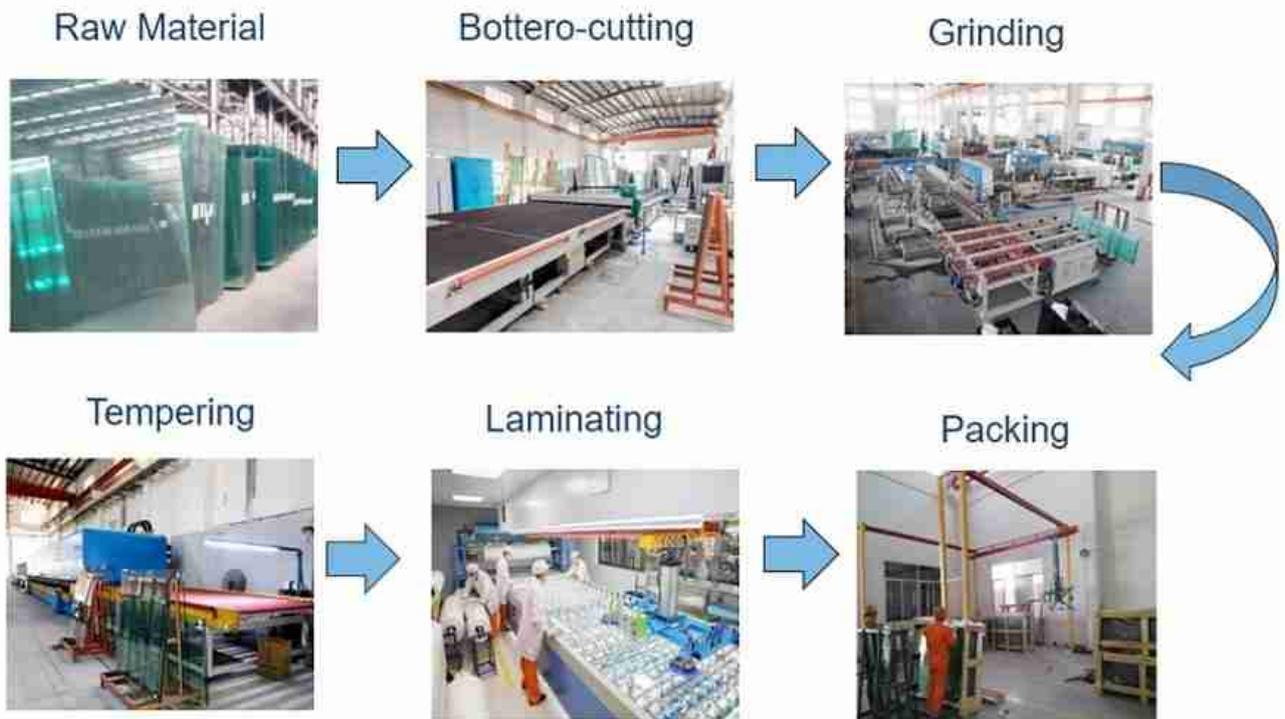
***Produktionsdetails von 10+1.52pvb+10mm klar gehärtetem Verbundglas balustrade für Decking***
