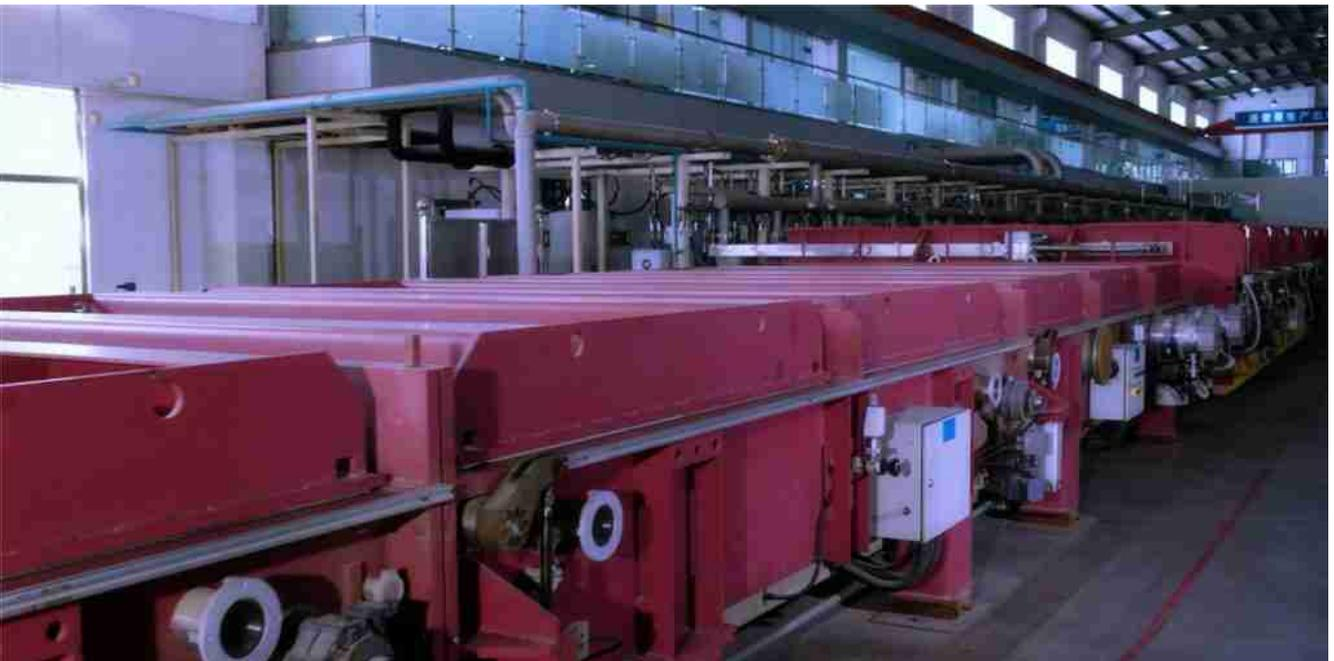
*Großflächige Sputterlinie für die Produktion von reflektierendem Glas.*
