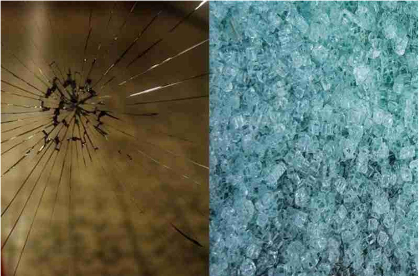
*gehärtetes Glas Bruch vs Float Glas Bruch*
