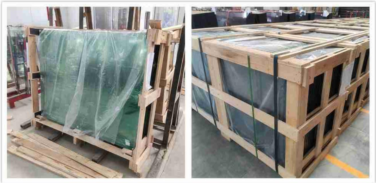
*Starke Sperrholzkistenverpackung, um die Sicherheit von gehärtetem Glas produkte während des Ferntransports zu gewährleisten.*
