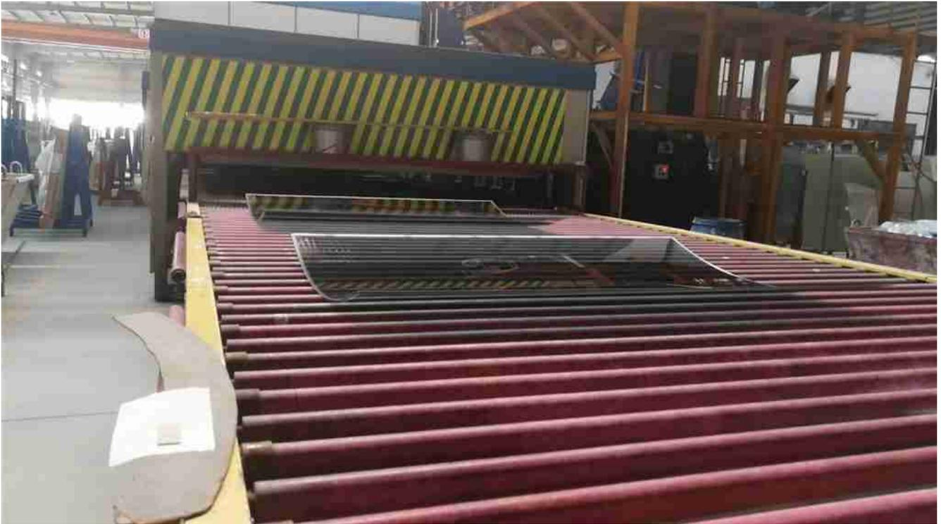
Gebogene gehärtete Glasproduktion und Temperieranlagen.
