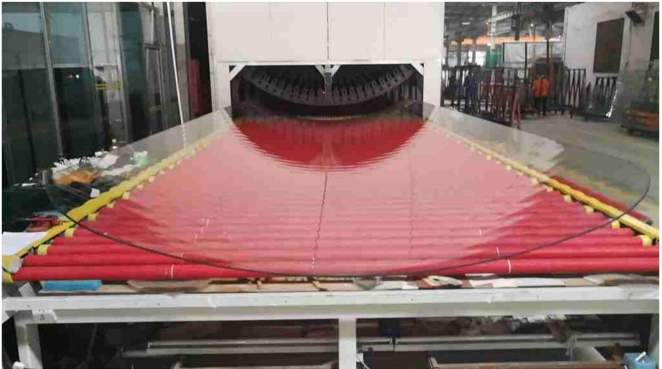
Gebogene Temperiermaschine zur Herstellung von gebogenem Glas
