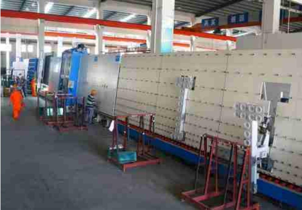
*Bystronic vollautomatische Dichtungslinien für Dreifachverglasung*
