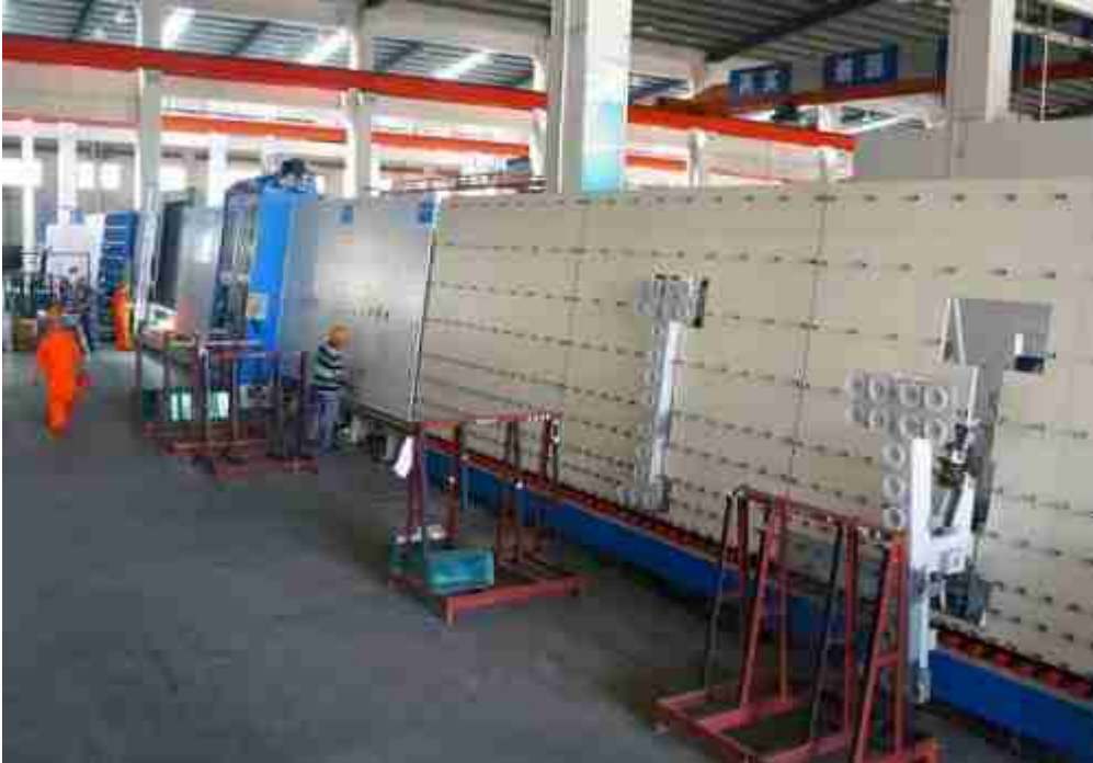
Bystronic vollautomatische Dichtungslinien für Dreifachverglasung
