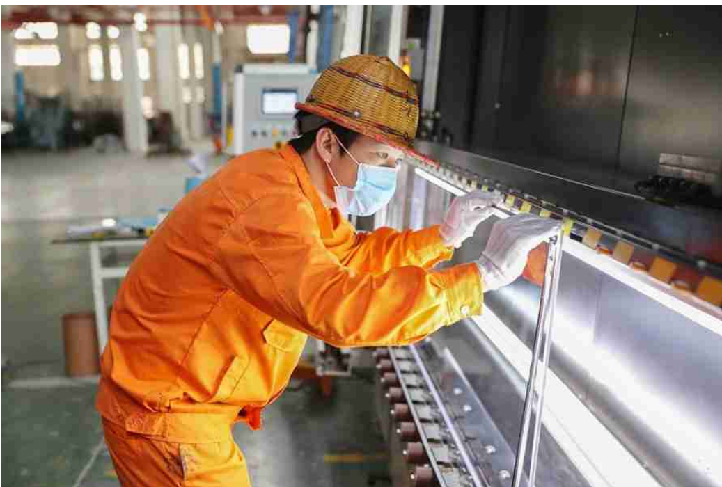
Sorgfältige Abstimmung des Butyl- und Aluminium-Abstanders mit dem Glas
