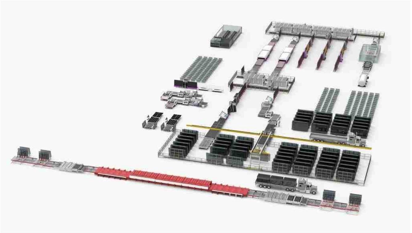
Das Bild oben ist der kurze Blick auf unsere intelligente Anlage. Es wird von der Firma Lisec aus Österreich gebaut. Die Gesamtleitung benötigt etwa 10 bis 15 menschliche Arbeitskräfte, während die Doppelisoliertglasproduktion (DGU) bis zu 60000SQM/Monat erreicht, das ist das 3-4-fache im Vergleich zur traditionellen Anlage.
