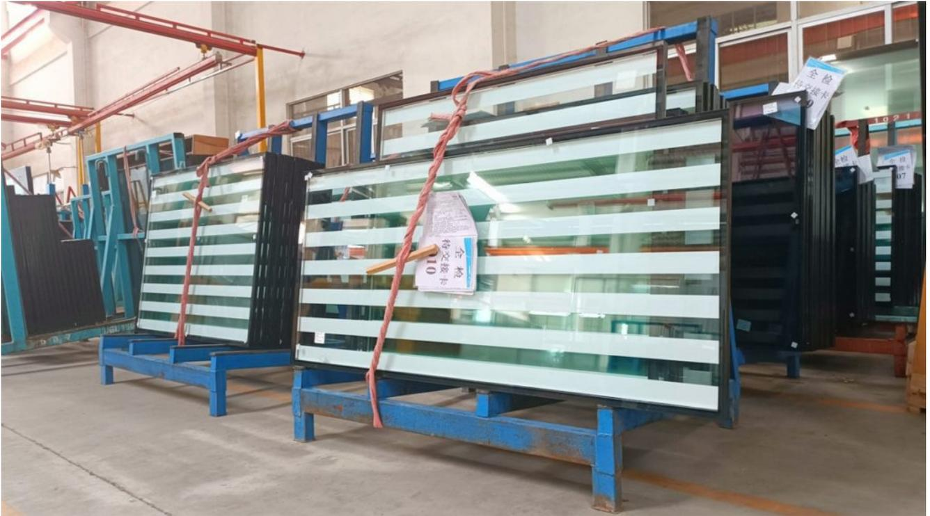
Auch bekannt als Isolierglasscheiben, Isolierglaseinheiten, Doppelisolierglasscheiben, Doppelscheibenfenster, doppelt verglaste Einheiten und versiegelte Glaseinheiten.
