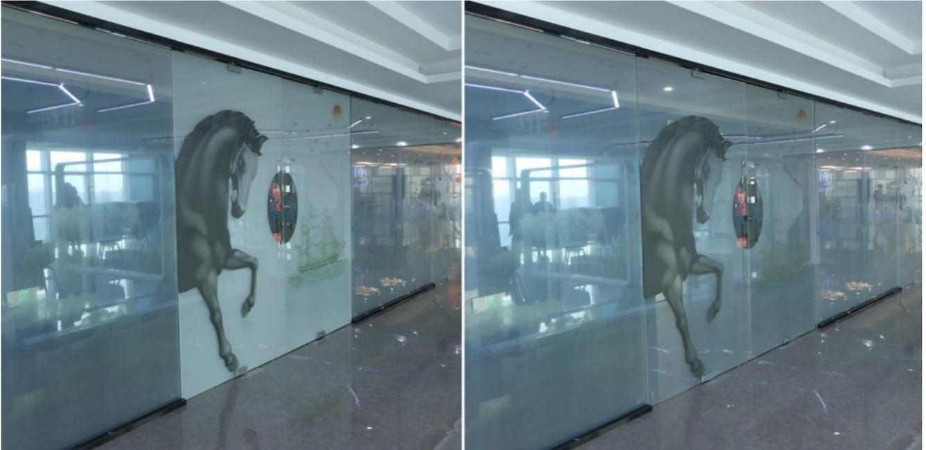
Smart Glass Electric ist auch als Smart Glass bekannt, schaltbares Glas ist Glas oder Verglasung, deren Lichttransmissionseigenschaften sich dynamisch ändern, um den Durchgang der Sonneneinstrahlung in Gebäude zu steuern. Im Allgemeinen wechselt das Glas zwischen transparent und transluzent und umgekehrt, lässt entweder Licht durch oder blockiert einige oder alle Wellenlängen des Lichts.
