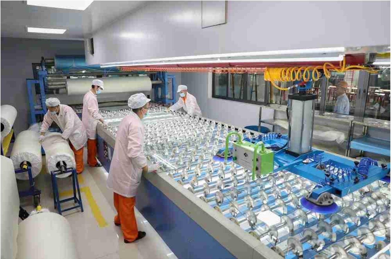
Die Herstellung von nassem Verbundglas und EVA-Verbundglas sollte in einer sauberen Umgebung verfugt/kombiniert werden, um eine Kontamination der Leim-/EVA-Folie während des Verfugungs-/Kombinationsprozesses zu vermeiden.
