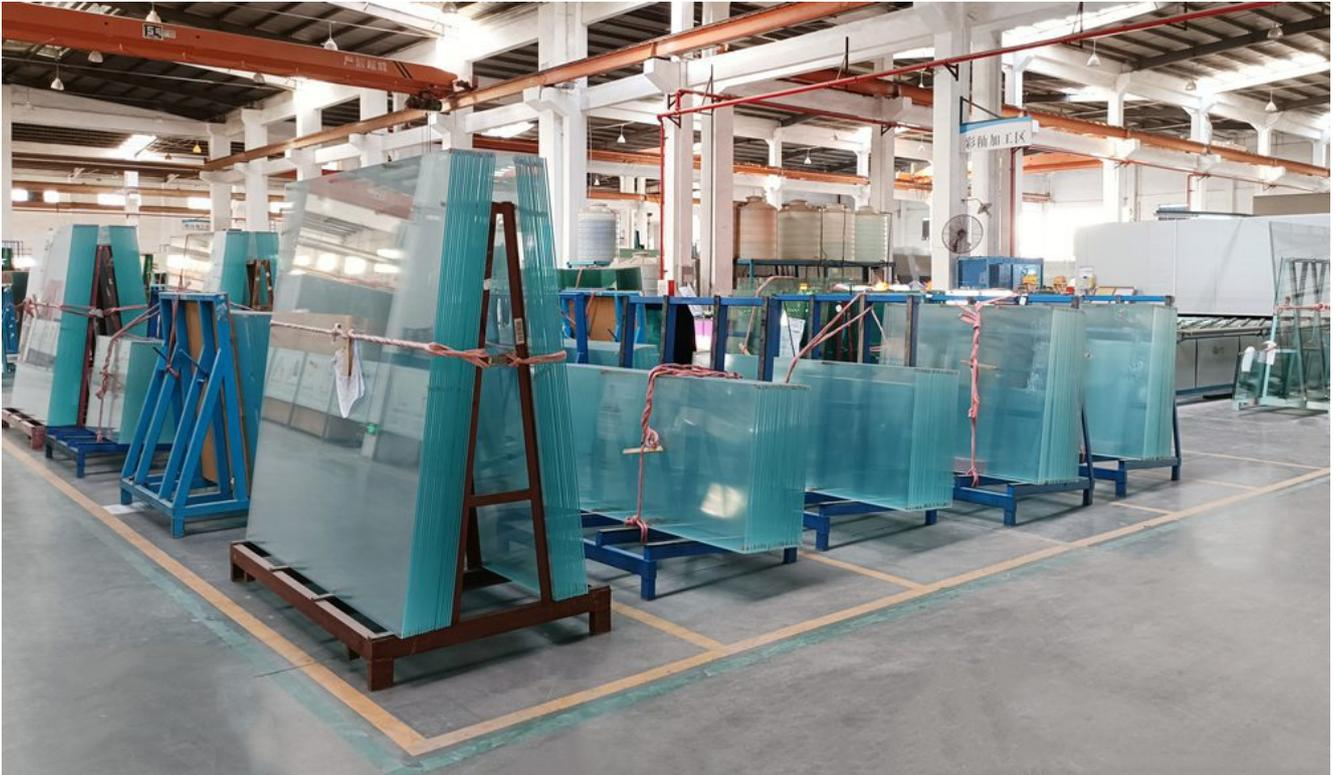
12mm optiwhite Aquarienglas ist ein eisenarmes, extraklares Floatglas mit sehr hoher Lichtdurchlässigkeit. Der Sand, der für Optiwhite-Aquarienglas verwendet wird, enthält nur 0,01 % Eisenoxid, und normal getempertes Glas hat zehnmals mehr. In kleinen Aquarien mit dünnem Glas fällt der Grünstich vielleicht nicht auf, aber bei dickerem Glas macht er einen deutlichen Unterschied, insbesondere durch das scharfe, weiße Rifflichtspektrum.
