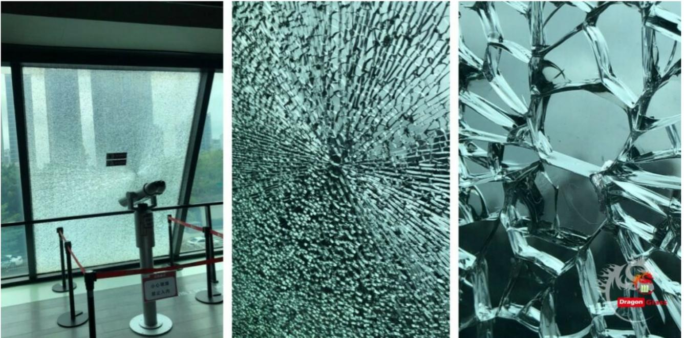
قد تحدث بلورات كبريتيد النيكل الصغيرة (NiS) في الزجاج المصهور أثناء عملية إنتاج الزجاج المصقول. عندما يتم تسخين الزجاج أثناء التشديد ، تزيد شوائب كبريتيد النيكل في الجزء الزجاجي من حجمها ؛ عندما يتم إخماد الزجاج الساخن بسرعة في عملية التشديد ، فإن الشوائب ، التي تحتاج إلى قدر معين من الوقت للعودة إلى حالتها الأصلية ، لا يمكنها القيام بذلك وتصبح "مجمدة" ، مما ينتج عنه تركيز إضافي للإجهاد المحلي.
