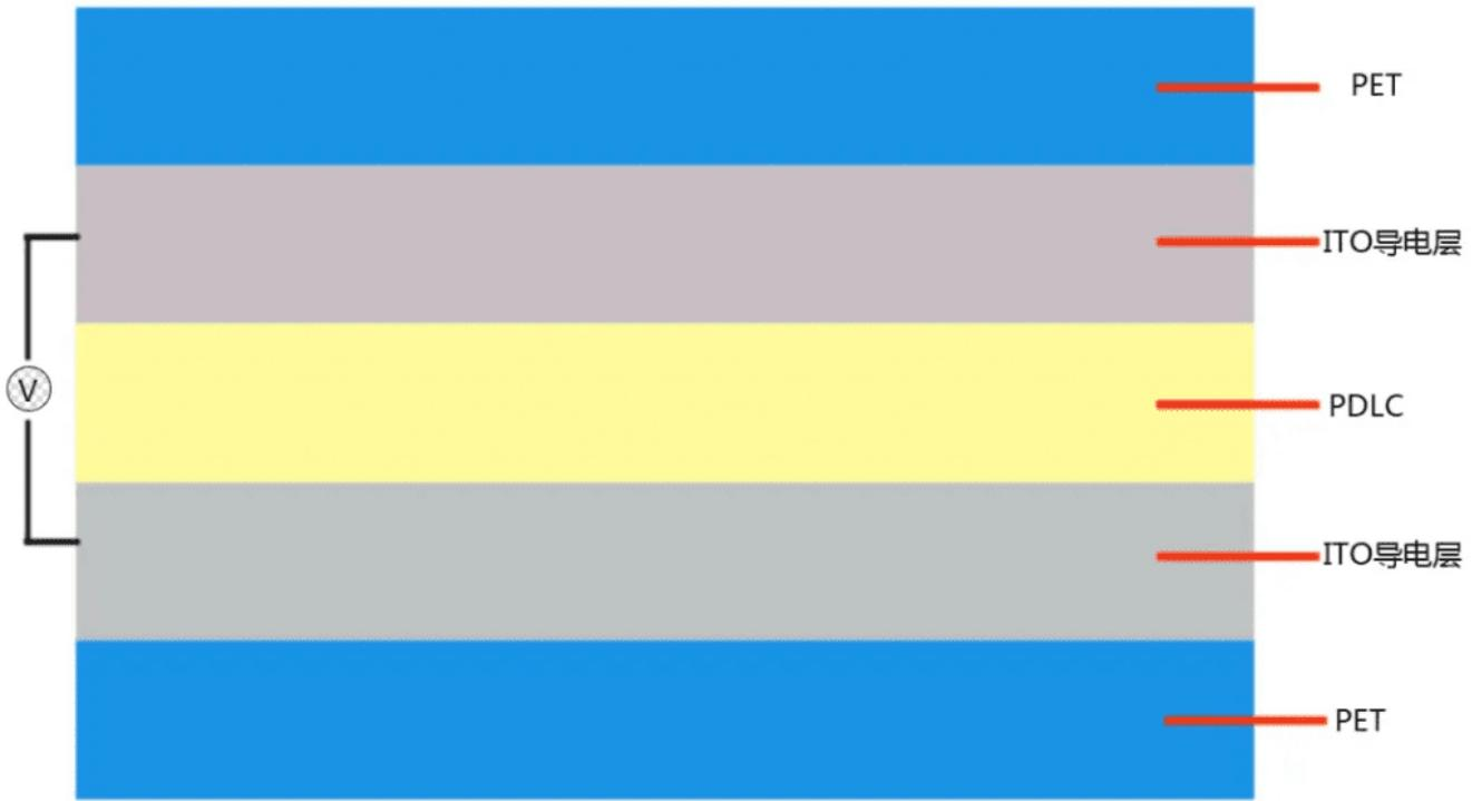
PDLC 智能玻璃 结构图
