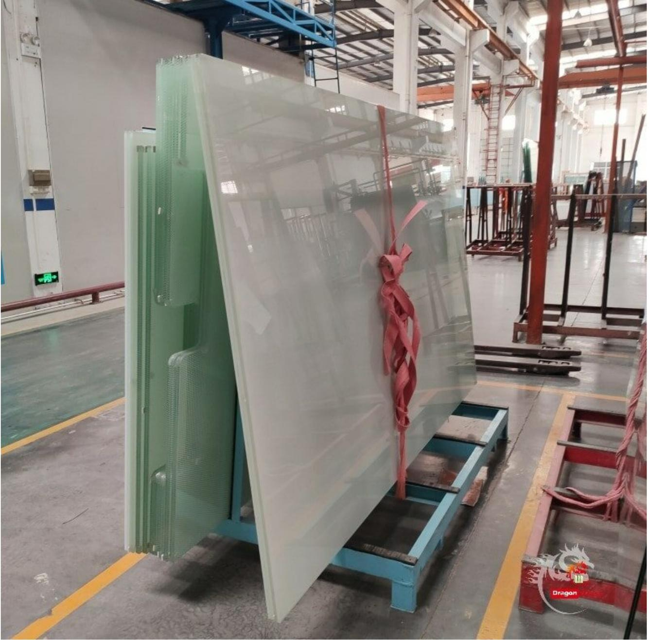
يكتسب الزجاج المقوى بالحرارة قوة جذب متزايدة كمادة مبتكرة للاستخدام في صناعة البناء والتشييد. عملية تقوية الحرارة هي نسخة متخصصة من تقنية التفسية الأكثر شيوعا ويمكن أن تنتج زجاجا بقوة فائقة ومستوى أعلى من مقاومة الكسر من الزجاج العادي أو المملدن.
